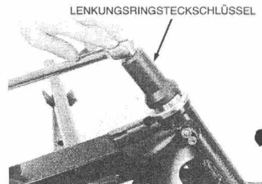
Lenkungsring mit Hand festhalten und oberes Lenkungsringsschraubgewinde, Staabdichtung, oberes Lagerinnengehäuse und oberes Lager abmontieren.
