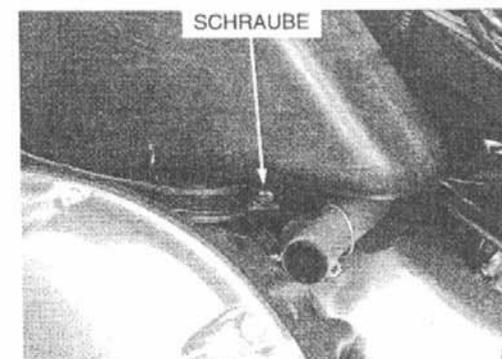
Den Schlauch des Regelventils für die gepulste Sekundärlufteinspritzung (PAIR) anschließen.
