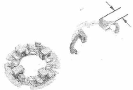
Auf Durchgang zwischen Startermotorklemme und positiver Bürste prüfen.
